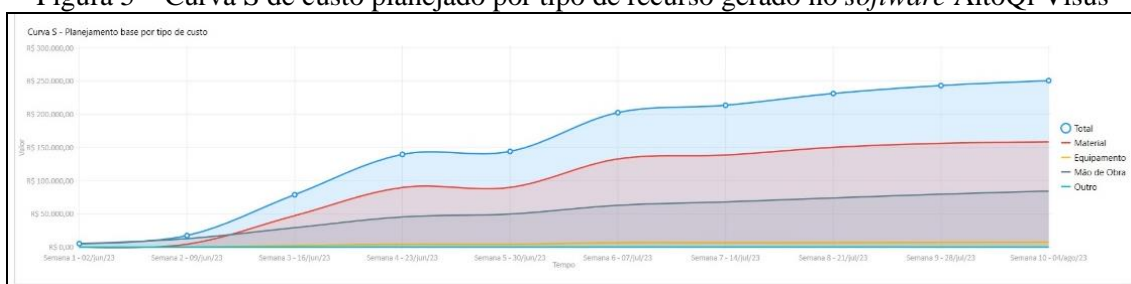
Figura 5 – Curva S de custo planejado por tipo de recurso gerado no software AltoQi Visus
