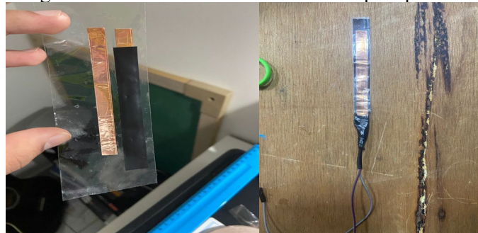
Figura 1 – Folhas de velostat envolvidas pelo plástico
