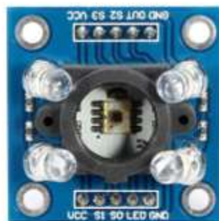
Figura 5- O Sensor de cor TCS3200 e suas aplicações
