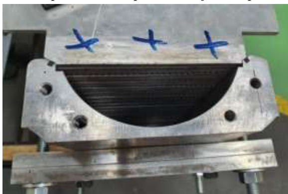
Figura 7 - Vista Superior da Tampa de Vedação Acoplada no Radiador
