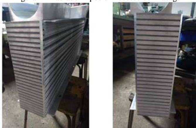
Figura 2 - Radiador Após o Processo de Brasagem
