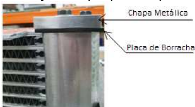
Figura 8 - Vedação Superior da Tampa
