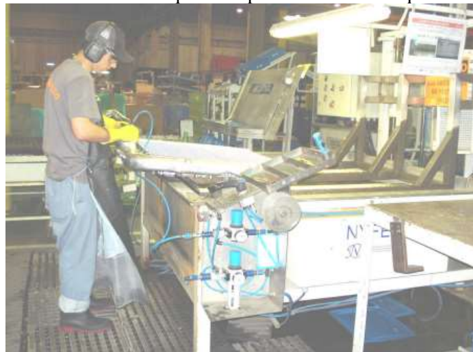
Figura 6 - Teste de estanqueidade por imersão em tanque com água
