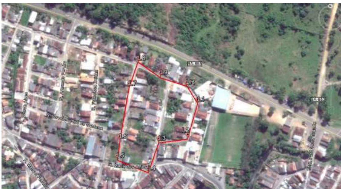
Figura 6 – Poligonal Topográfica Fechada Englobando a Área de Estudo
