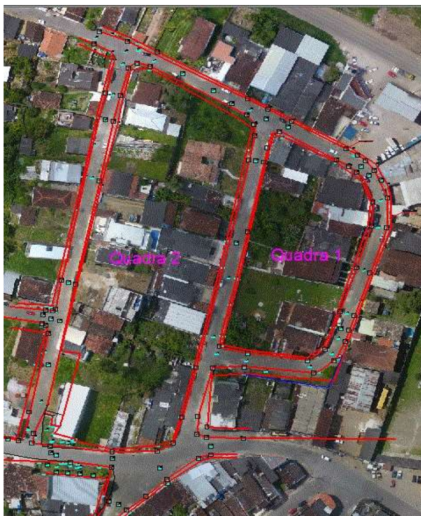
Figura 8 – Sobreposição do Levantamento Topográfico Convencional ao Ortomosaico Gerado pelo Levantamento com RPA
