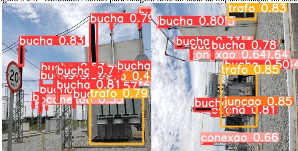
Figura 5 e 6 - Resultados obtido para imagem teste do local de implementação do sistema
