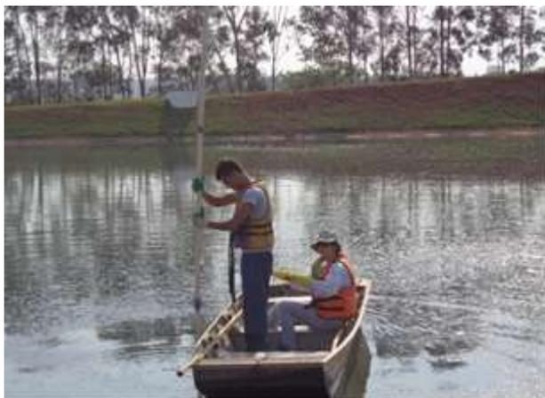
Utilizou-se o software SURFER 8.0 para calcular o volume de lodo depositado nas lagoas anaeróbias e também a distribuição espacial do mesmo. Os volumes encontrados na lagoa receptora e testemunha foram comparados antes e depois da codisposição dos resíduos de fossas e tanques sépticos, a fim de se obter o incremento da quantidade de lodo gerada nos períodos estudados.
