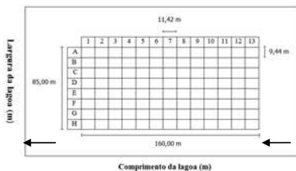
Os dados do volume de lodo antes do isolamento do Módulo Receptor foram obtidos por meio de medições das alturas da camada de lodo no fundo das lagoas anaeróbicas, realizadas em novembro de 2012. A etapa que contemplou avaliar as possíveis interferências no aumento do volume do lodo depositado nas lagoas anaeróbicas, após a codisposição dos resíduos de fossas e tanques sépticos, foi realizada no final do mês de maio de 2013.
