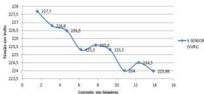
Finalmente, por meio da comparação dos resultados com instrumentos comerciais de medição anteriormente descritos, verificou-se que o desvio médio percentual apresentado pelo medidor de tensão desenvolvido foi cerca de 3%.
