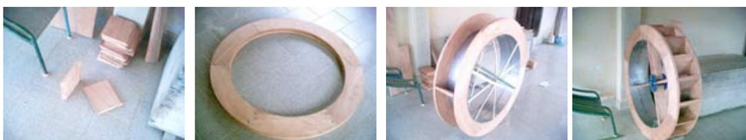
Figura 1-Etapas da construção da roda d'água feita de madeira.
