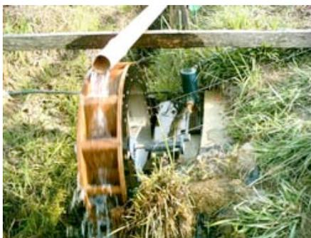
Figura 5a –Acionamento da bomba de água com haste curta
