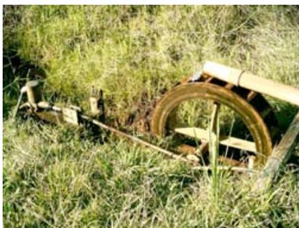
Figura 5b –Acionamento da bomba de água com haste longa
