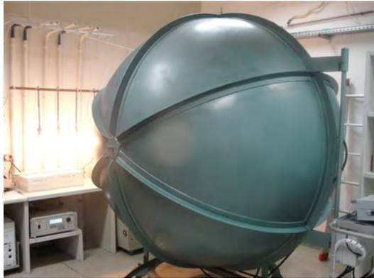
Figura 2 – Esfera Integradora para ensaios em LFC's
