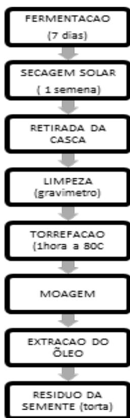
Figura 1- Fluxograma do processamento para obtenção da torta de cupuaçu
