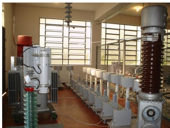
Figura 3 – Linha de transmissão artificial montada em laboratório
