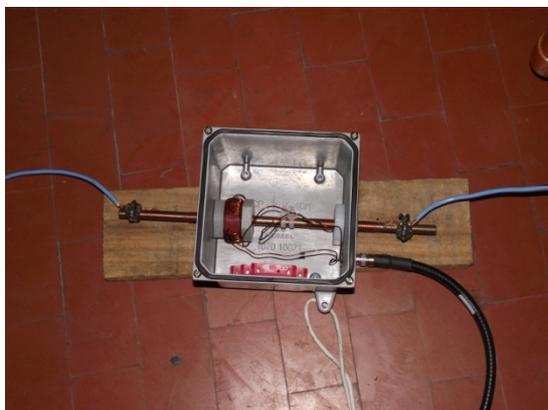
Figura 6 – Transdutor de corrente conectado a carcaça do TC
