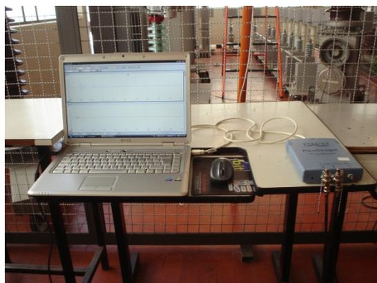
Figura 4 – PC e placa de aquisição
