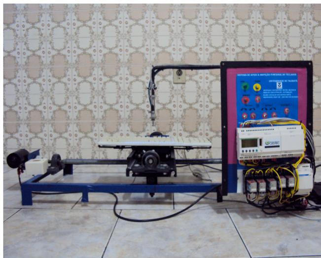
Figura 1 – Protótipo-da mesa XY
