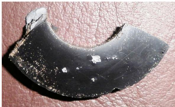
Figura 7 - Ferrita c, de maior diâmetro, após submetido ao ensaio de macrodureza Rockwell A
