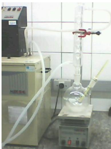
Figura 2 – Configuração do equipamento utilizado na transesterificação
