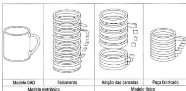
Figura 1 - Representação das principais etapas do processo de manufatura por camada
