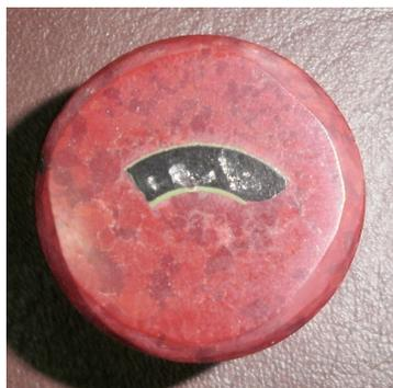
Figura 5 - Ferrita a, de menor diâmetro, após submetido ao ensaio de macrodureza Rockwell A
