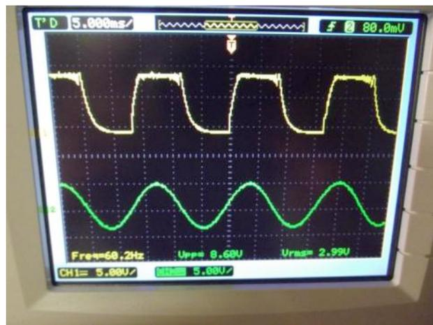
Figura 21 – Saída do Conversor F/V com distorção
