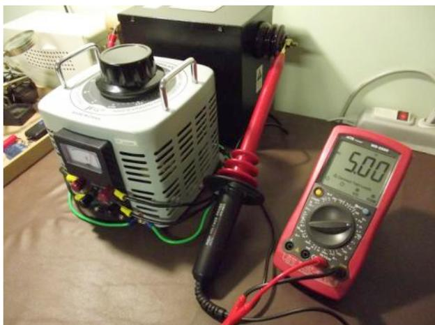
Figura 3 – Foto da Fonte de Alta Tensão Variável
