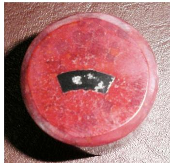
Figura 6 - Ferrita b, de diâmetro intermediário, após submetido ao ensaio de macrodureza Rockwell A
