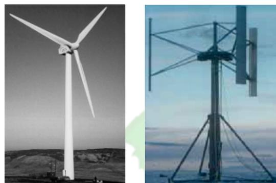
FIGURA 1 – DA ESQUERDA PARA A DIREITA: AEROMOTOR DE EIXO HORIZONTAL E AEROMOTOR DE EIXO VERTICAL TIPO ROTOR H.
