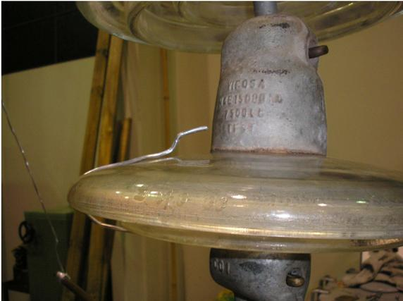
Figura 10: Técnica de geração de ruído no isolador.
