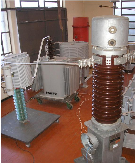
Figura 4: TC, bobina de bloqueio, transformador e reator.
