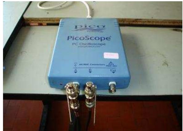
Figura 7: Placa de aquisição de dados PicoScope 3205.
