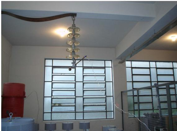
Figura 5: Cadeia de isoladores de vidro com condutor que simula o efeito corona.
