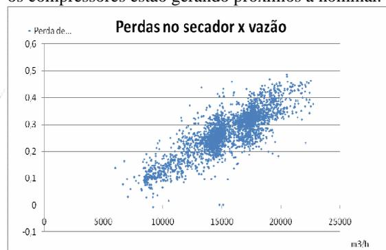
Fig. 14. Curva de perdas no secador versus a vazão.
