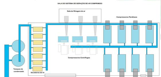
Fig. 9. Desenho do arranjo físico dos compressores dentro da sala de geração de ar comprimido.
