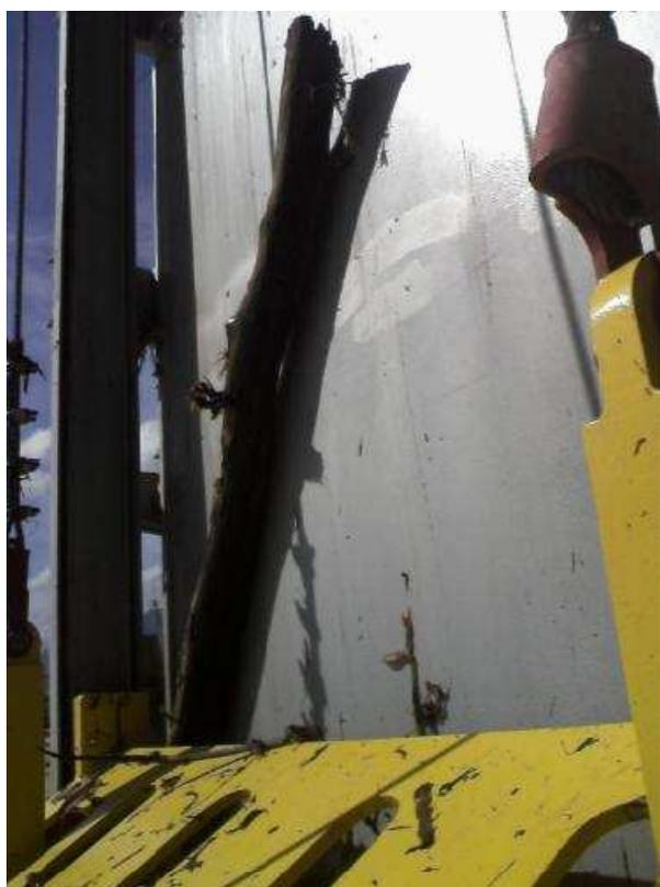
Fig. 8 – Tronco retirado pelo rastelo do painel da grade (do autor)
