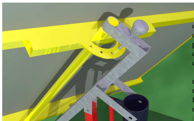
Fig. 8. Suporte do painel fotovoltaico e seu sistema de ajuste manual das estações do ano.
