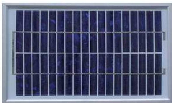
Fig. 1. Pequeno painel fotovoltaico de 5w utilizado nos testes de campo.
