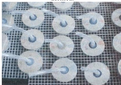
Figura 6 - Configuração dos corpos de prova imersos em água sobre a grelha acrílica.
