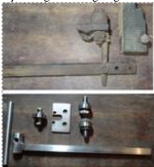
Figura 8 - Confeção da guia de regulagem da Lâmina de Serra.
