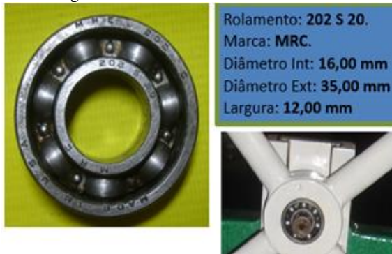
Figura 5 - Rolamento do Volante Movido.
