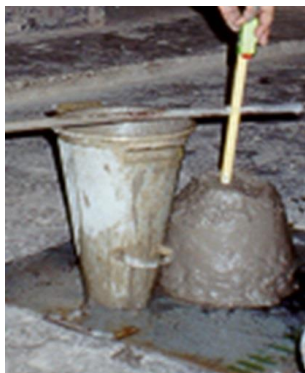
Figura 5 - Ensaio de abatimento, conforme a NBR NM 67 (1998).
