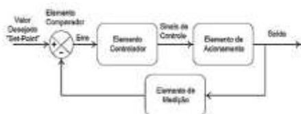
Figura 2 - Sistema de controle malha fechada
