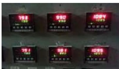
Figura 11-Temperatura após a auto sintonia
