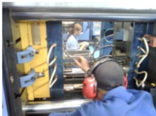
Figura 2 - Preparação e verificação da fase espelhada do molde
