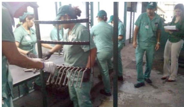
Figura 4 - Organização das peças no suporte para secagem antes da pintura
