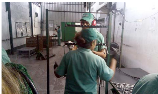
Figura 3 - Organização das peças no suporte para secagem antes da pintura
