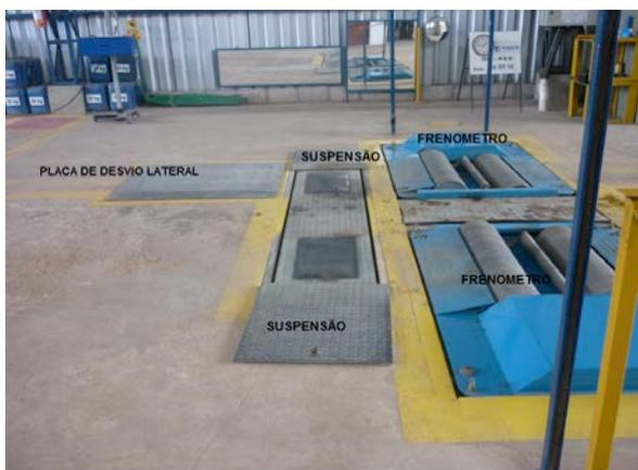
Figura 2 - Foto Linha de Inspeção
