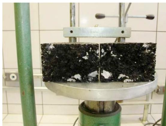
Figura 3 - Detalhe de corpo de prova seco do ensaio Lottman rompido, traço A30G100
