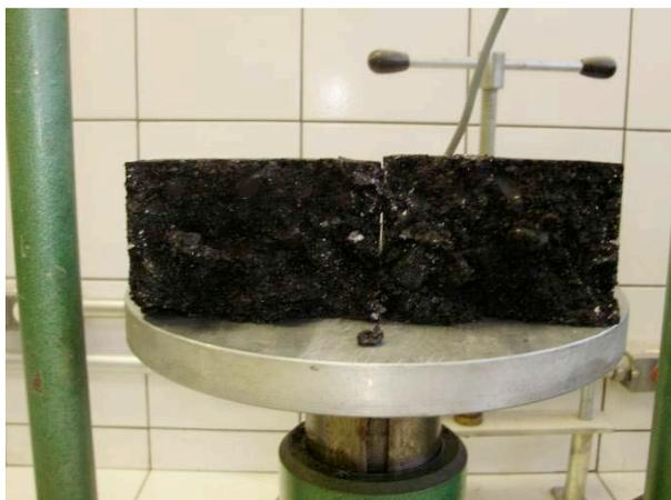
Figura 5 - Detalhe de corpo de prova seco do ensaio Lottman rompido, traço AN
