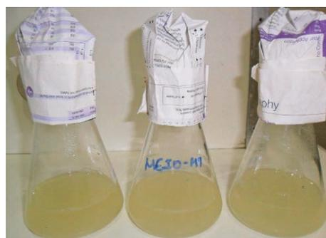
Figura 4 - Meio líquido de cultivo M9 utilizado na fermentação
