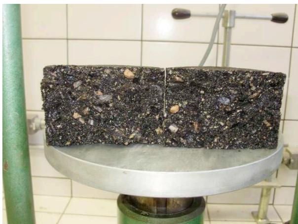
Figura 6 - Detalhe de corpo de prova saturado do ensaio Lottman rompido, traço AN
