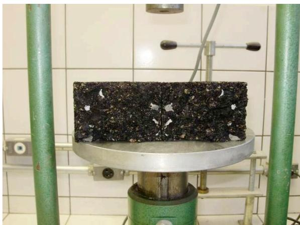
Figura 4 - Detalhe de corpo de prova saturado do ensaio Lottman rompido, traço A30G100
