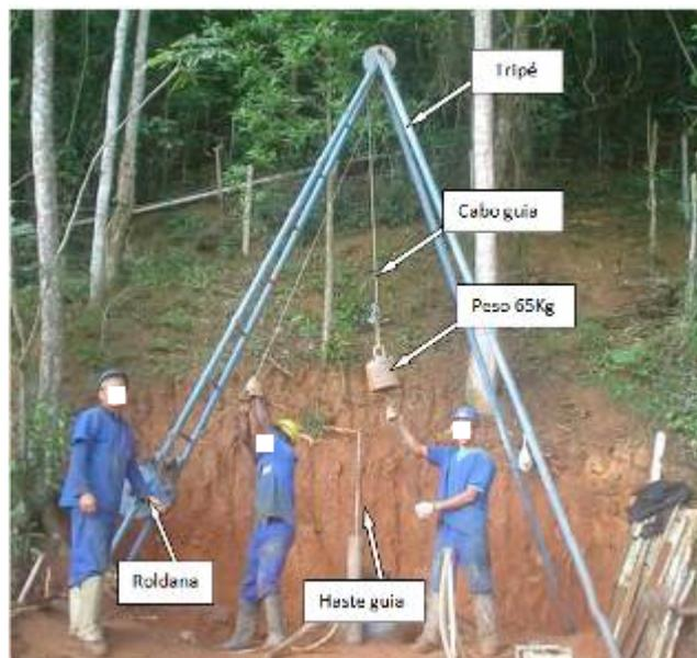
Figura 2 - Equipamento para ensaio a percussão SPT (servissondagem, 2014)
