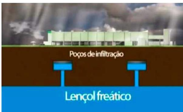
Figura 6 - Poços de infiltração. Fonte: LEITE, 2011
