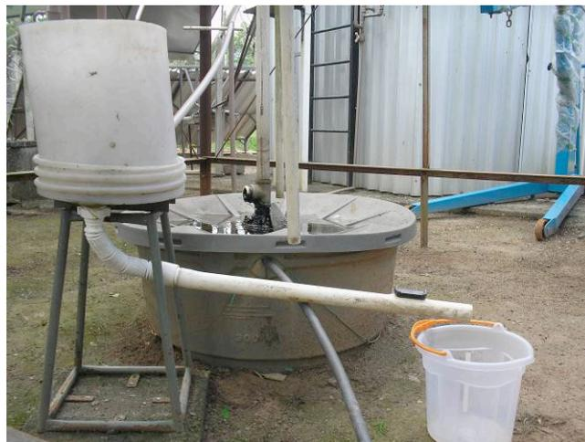
Figura 4 – Água de escape sendo recolhida em balde graduado
