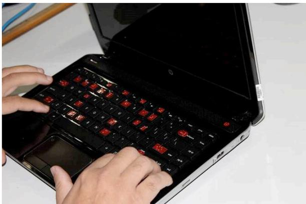
Figura 6 – Computador com as adaptações necessárias para facilitar a localização das teclas
