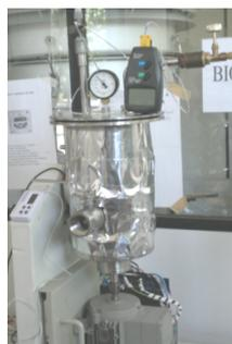
Figura 3 - Biodigestor anaeróbico em escala laboratorial
