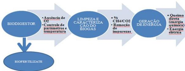
Figura 1 - Esquema geral do processo de biodigestão anaeróbica na produção de energia. Fonte: Elaborado pelos autores.
