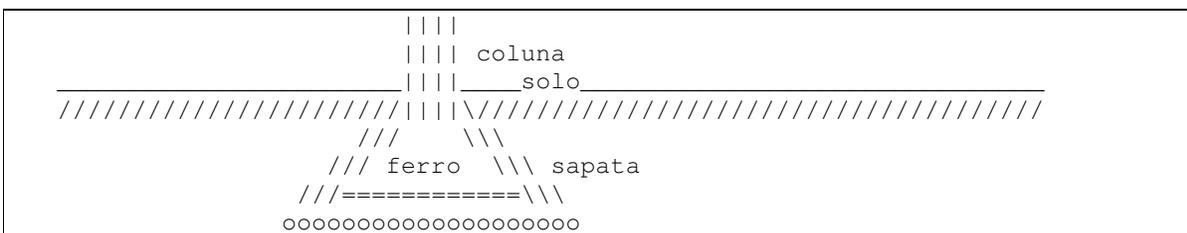
Figura 14- Sistema de aterramento para sapata de concreto
